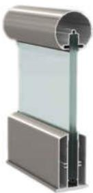
Typ A10 zur aufgesetzten Montage auf einem durchlaufenden Aluprofil. Geeignet für den Einsatz von Sicherheitsglas in einer Stärke von 10mm. Der Abschluss erfolgt durch einen Handlauf.
