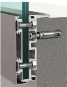
Typ Dc zur vorgesetzten Montage. Die Vorkopfhalterung besteht aus einem Aluminiumprofil, welches frontal angebracht wird. Geeignet für Glasstärken von 16mm und 20mm. Ein Blendprofil wird zur Abdeckung vorgesetzt.
