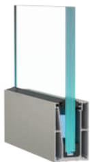
Typ Slim line zur aufgesetzten Montage. Anbringungen der Aluprofilschiene auf dem Boden. Verschiedene Glasstärken sind möglich (10mm, 12mm, 16mm und 20mm). Glasscheiben bis zur einer Höhe von 1200mm einsetzbar.
